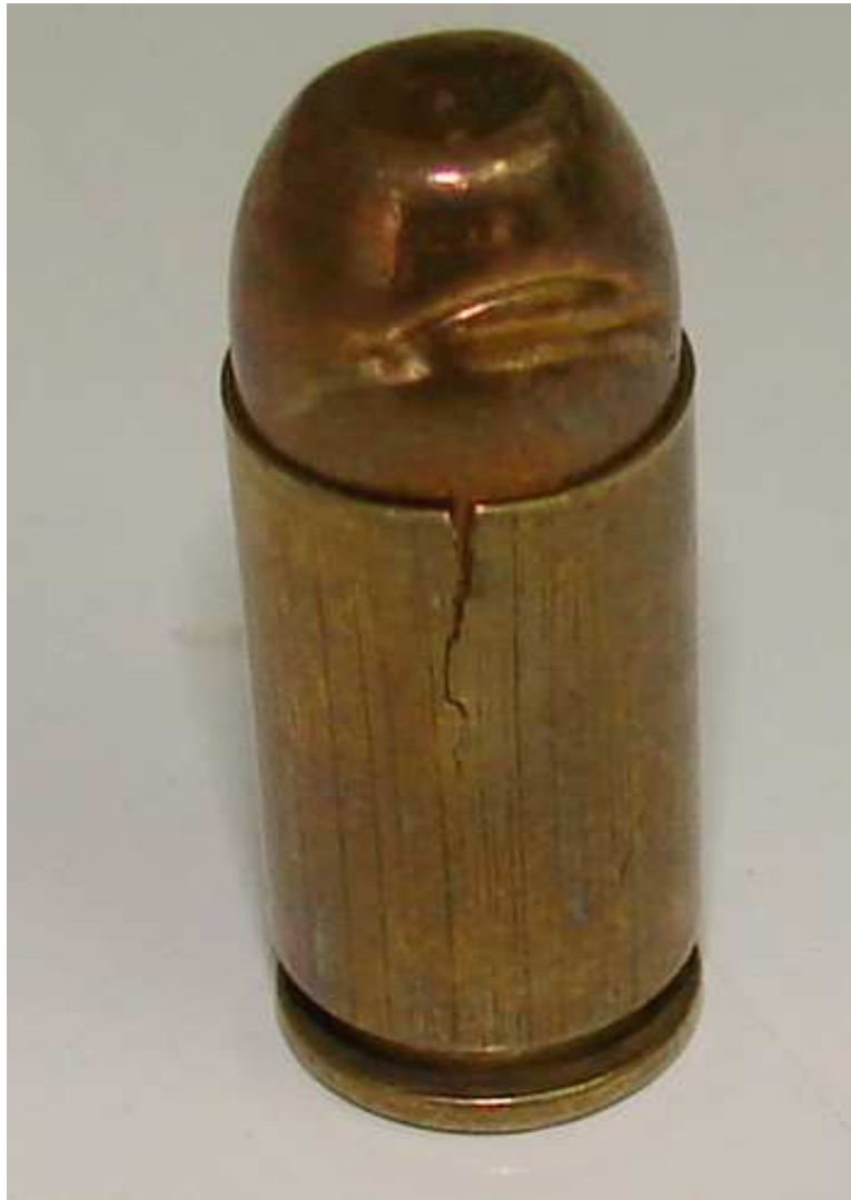
FIGURA 3 – Aspecto geral de um estojo metálico com rachadura. O projétil também foi danificado por falhas na prensagem Fonte: Seção de Recarga de Munições do Centro de Material Bélico (CMB).
