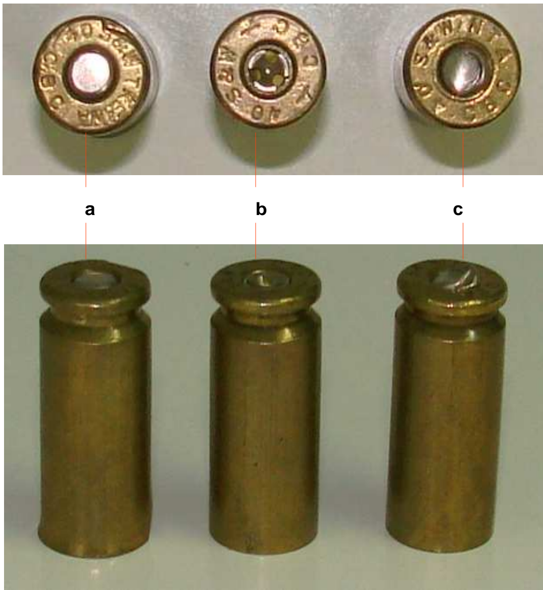
FIGURA 4 – Inconformidades ocorridas durante a montagem mecanizada Fonte: Seção de Recargas do CMB
